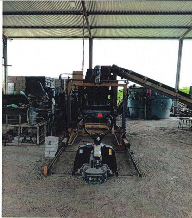
**Foto nº 01 – Máquina Hidráulica fabricação de blocos**
