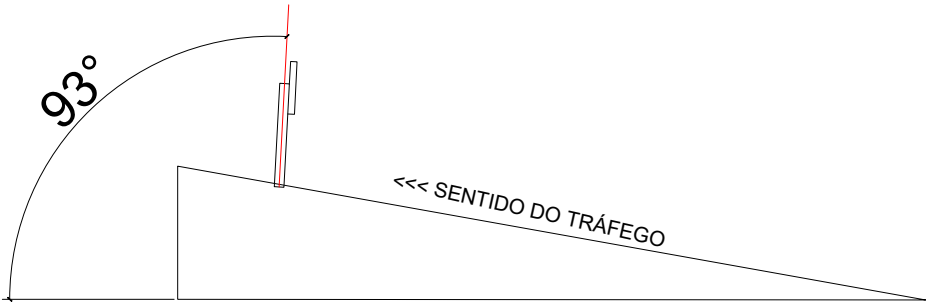
RAMPAS ASCENDENTES - DEFLEXÃO VERTICAL
